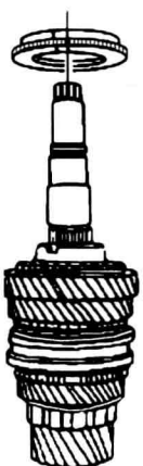
(9) 拆下 1/2 档齿轮锁环
