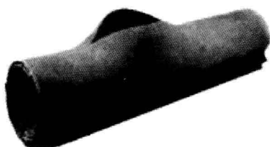
图 1-3 管道局部过热而引起的破裂
