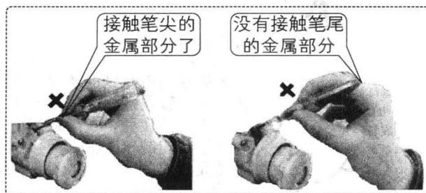
图 1-11 低压验电笔不正确使用方法
