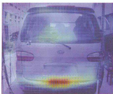
图 7.2.54 重建获得后舱门在 1500~3000Hz 分析频段上有功声强分布
