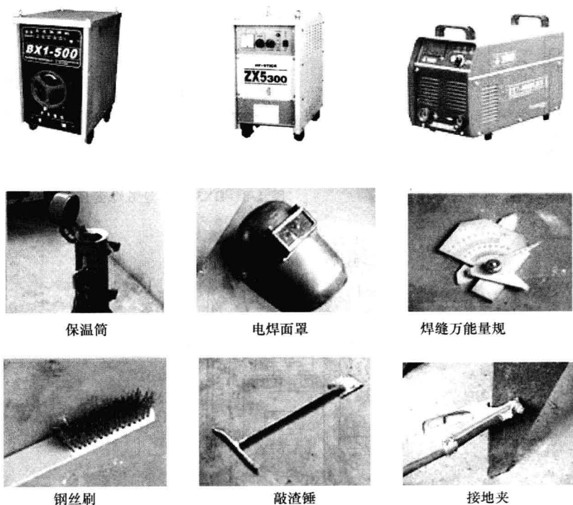
图 1-10 焊条电弧焊防护用具
