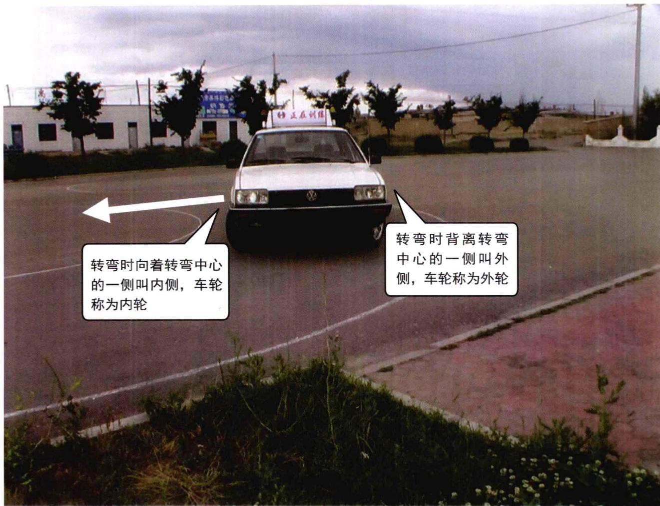
转弯时向着转弯中心的一侧叫内侧，车轮称为内轮
