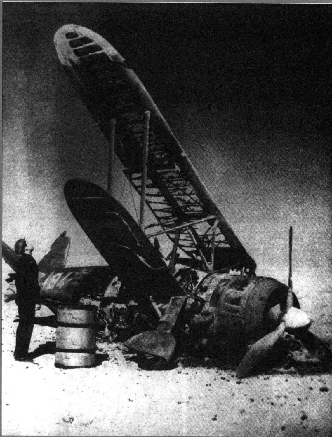
在利比亚，这架FLAT C·R·42双翼飞机降落时由于一只轮子脱落而坠毁在西部沙漠。
