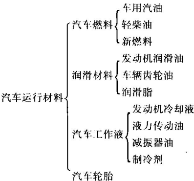
图 1.6 汽车运行材料的分类
