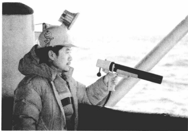
中国政府第一次派往南极的两名科学工作者之一，国家海洋局第二海洋研究所助理研究员董兆乾于1980/81年被派赴南极考察，图为他在极地抗冰船“内拉顿号”上测量南大洋水温随深度的变化
