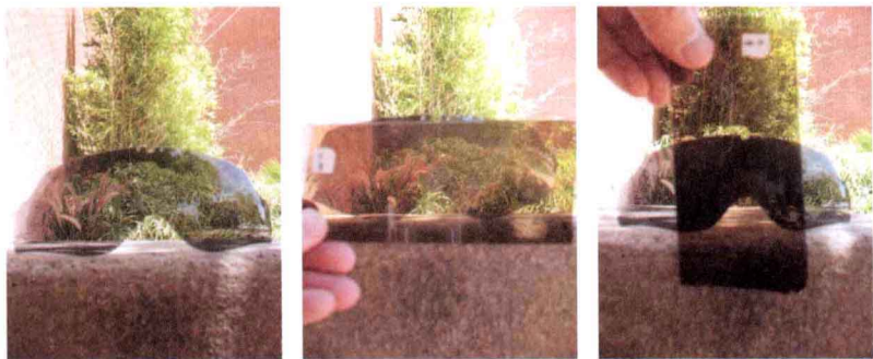
图1.2 用已知偏振方向的偏振片判断太阳镜的偏振方向
