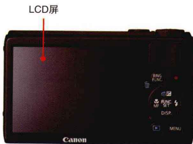
▲DC均以机背的LCD屏取景，少数DC可以配用EVF电子取景器。
