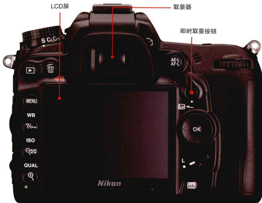
▲DSLR配备光学取景器，也有LCD屏作即时取景，少部分DSLR以EVF取景取代光学取景。
