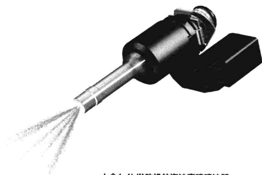
大众1.4L发动机的汽油直喷喷油器
