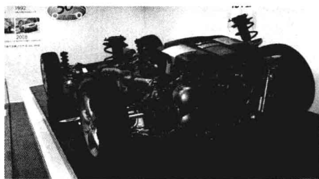
水平对置发动机的低重心特性造就了它的运动天性
