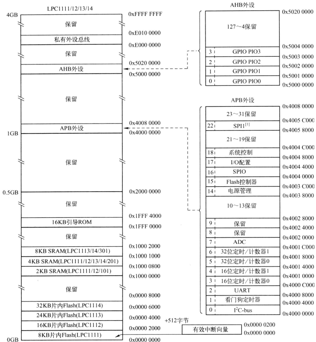
图 1-2 LPC1111/12/13/14 系统存储器地址空间映射
