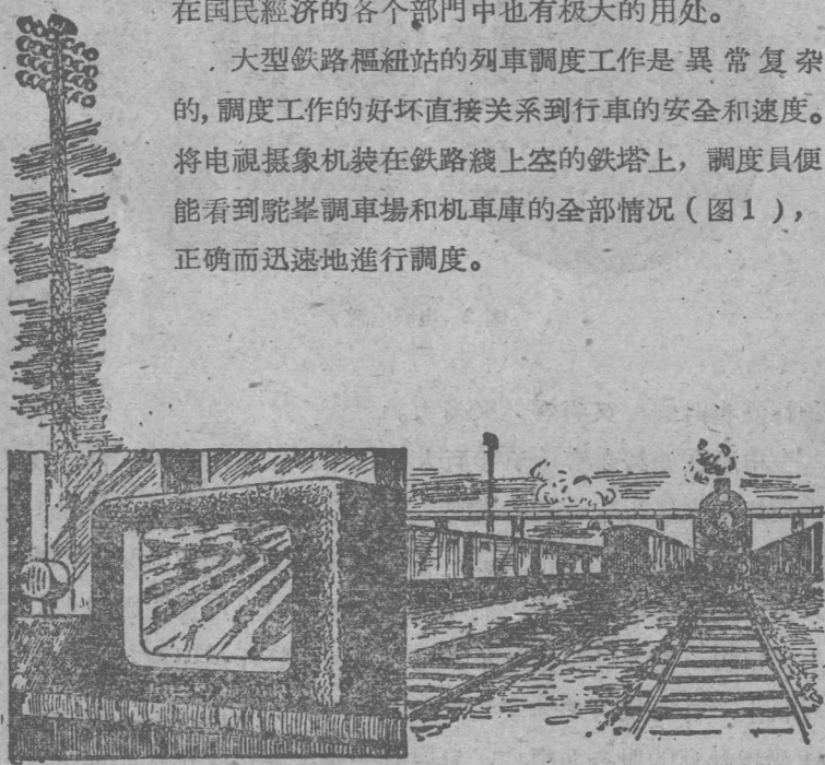
圖 1 將電視攝象機裝在鐵線上空的鐵塔上，調度員便能看到駝峯調車場的全部情況
