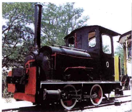
图 1.4 中国自造的第一台 0-3-0 型的蒸汽机车
