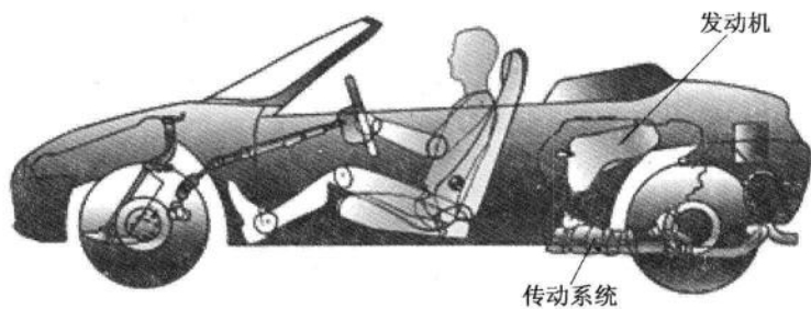
图 0.8 发动机中置后轮驱动 (MR) 示意图
