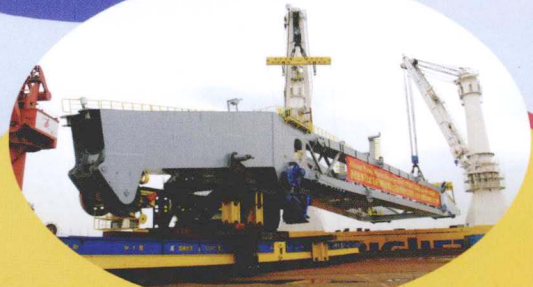
开发区豪氏威马钢铁公司研制的全球最大桅杆式起重机下线
