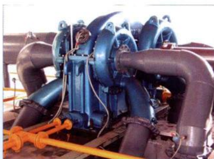
透平空压机 ( 600 \sim 40000 \text{ m}^3/\text{h} 空分配套)
