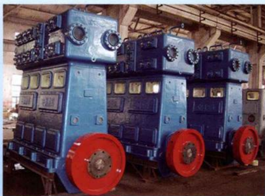
氧、氮压缩机 ( 800 \sim 6500 \text{ m}^3/\text{h} )
