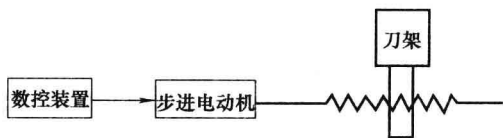
图 1-1-5 开环控制系统框图
