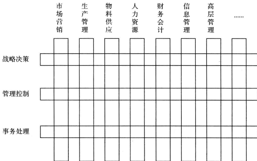
图 1-3 管理信息系统的功能结构图
