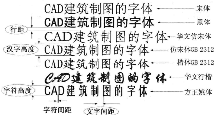
图 1.6 建筑施工 CAD 制图字体间距
