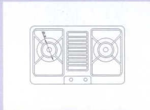
实例 164 直径标注燃气灶图形
