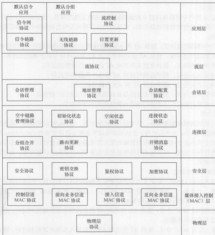
图 1-5 EV-DO Rev.A 空中接口协议栈
