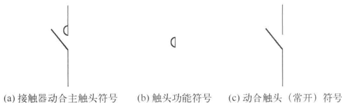
图 1.1.1 接触器动合主触头符号组成
