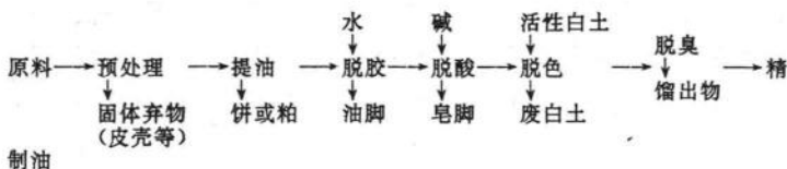
植物油厂典型生产工艺流程
