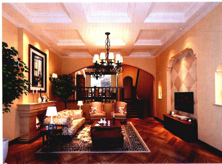
电视墙 [ 双色仿古砖斜铺 + 石膏板造型 + 彩色乳胶漆 ]
