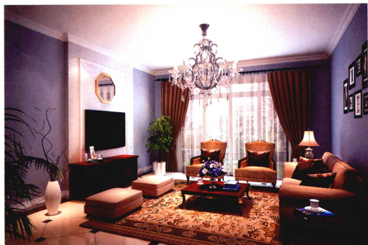
电视墙 [ 水曲柳饰面板显纹刷白 + 装饰镜 + 彩色乳胶漆 ]
