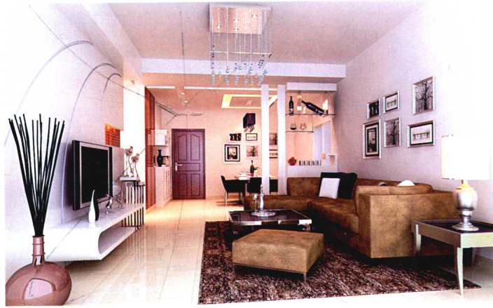
电视墙 [ 石膏板造型拓缝 + 马赛克 ]
