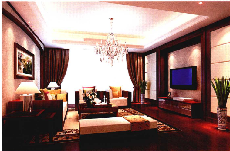
电视墙 [ 墙纸 + 饰面板装饰框 + 布艺软包 ]
