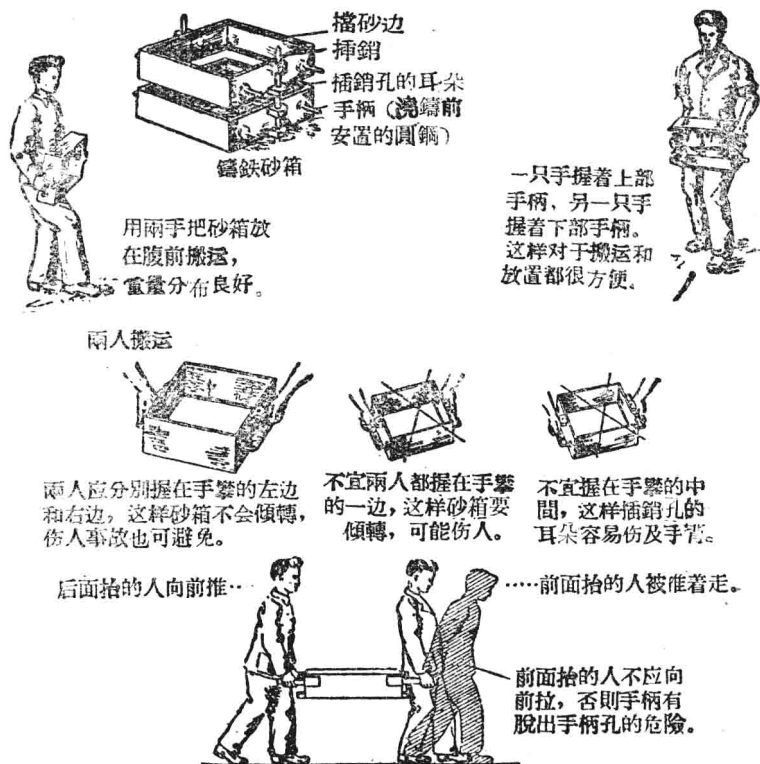
圖 6 砂箱的正确与不正确的搬運。
