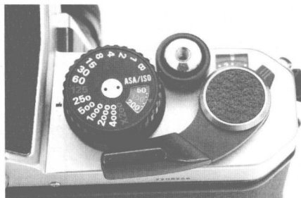
图 1-1 照相机上各级快门速度 (陈喆 摄影)
