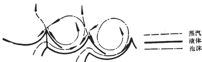
图 5-1 Kittel 和 Schneider 1937 年提出的动力塔板的流动特性
