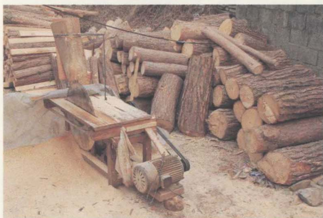
图12-3 官渡座椅使用的材料马尾松和电锯
