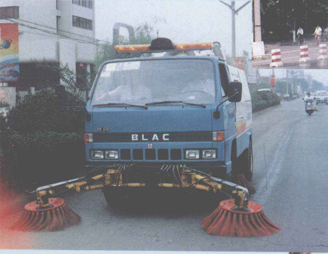
市环卫处机械清扫车正在清扫路面
