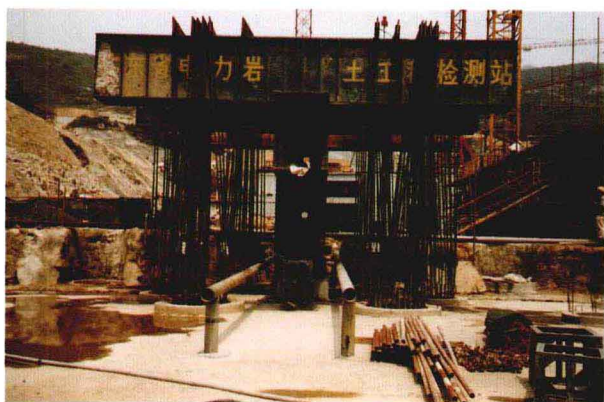
挖孔桩锚桩法静载试验
