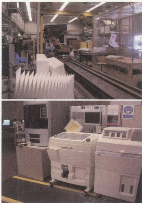
图0-4 美国某大学建筑学院实习车间，前景机械为具有三维成型功能的智能化雕刻设备；下为用于三维模型输出的三维打印机。
