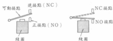
可動接點和NC接點及NO接點接觸的時間都是 \frac{1}{4} sec.。
