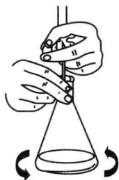
图 2-5 酸式滴定管锥形瓶滴定操作
