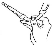
图 2-3 碱式滴定管气泡排除
