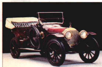
1910年，最高时速：80 km/h， 发动机功率：29 kW（转速为1 230 r/min）
