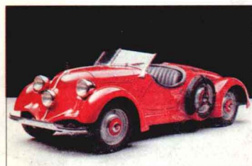
1935年，最高时速：140 km/h， 发动机功率：40 kW（转速为4 500 r/min）
