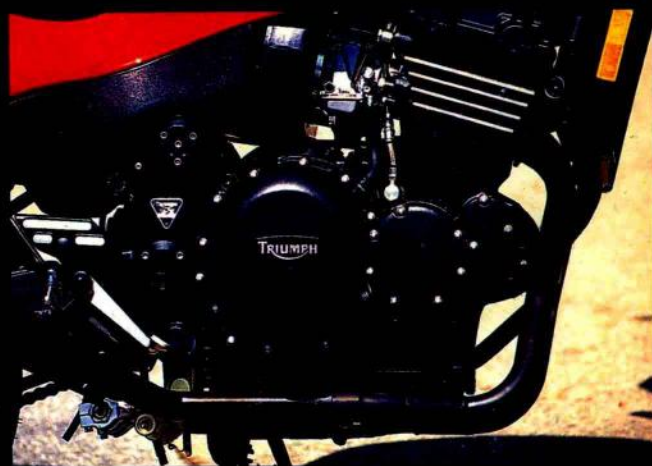
以黑色为主的三缸引擎，在美感流露中更可输出达 98ps 的马力
