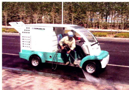
高压清洗车冲洗路牙石
