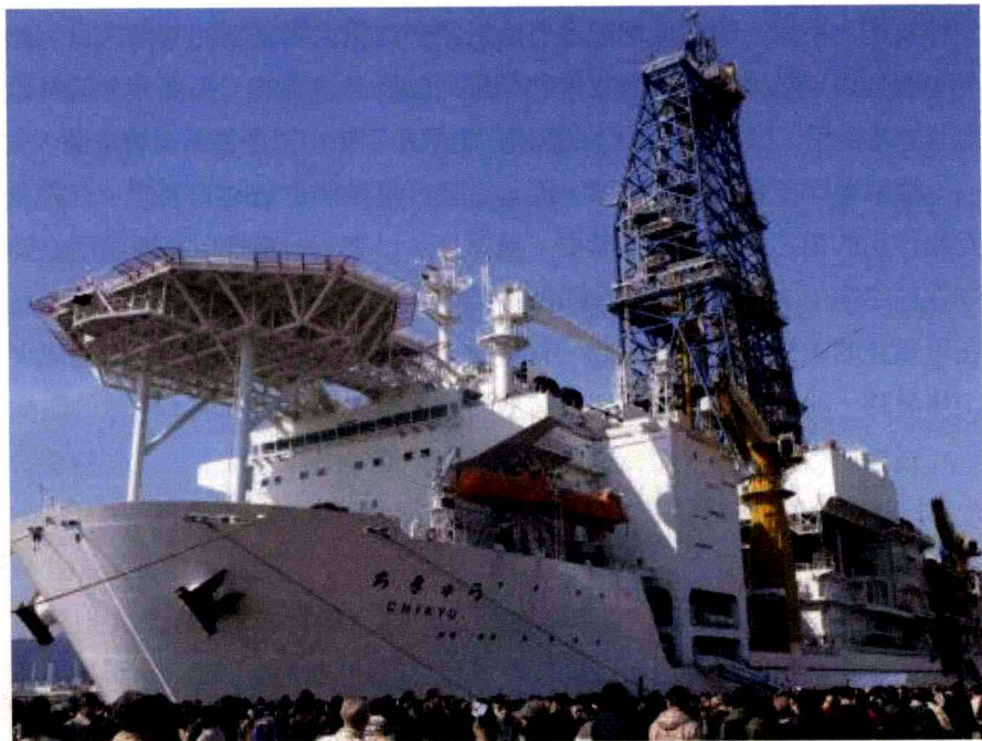
圖 I.1 日本地球號是世界上最先進的科學鑽探船，它可以從水深 2,500 公尺的海床，向下鑽 7,000 公尺。日本地球號屬於「整合海洋鑽探計畫」（Integrated Ocean Drilling Program, IODP）的一部分。（Photo by kayakaya/Flickr）
