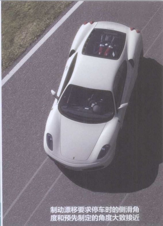
驱车助跑，一边转动转向盘，一边踩下制动踏板，使车身产生侧滑并稳稳停住
