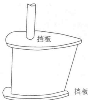
图 1-3 舵叶上、下端设置挡板
