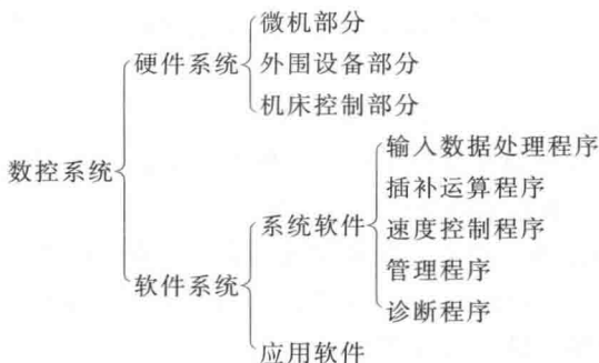
图 1.1 数控系统总体构成框图
