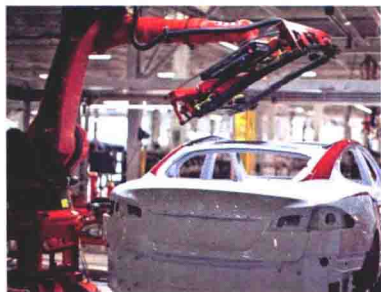
图 1-3 工业机械手在进行汽车天窗的安装
