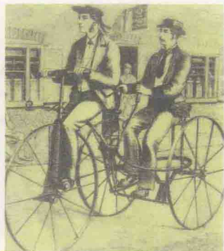
1861年,皮埃尔·米肖制作的三轮自行车,前轮安装了脚踏装置。
