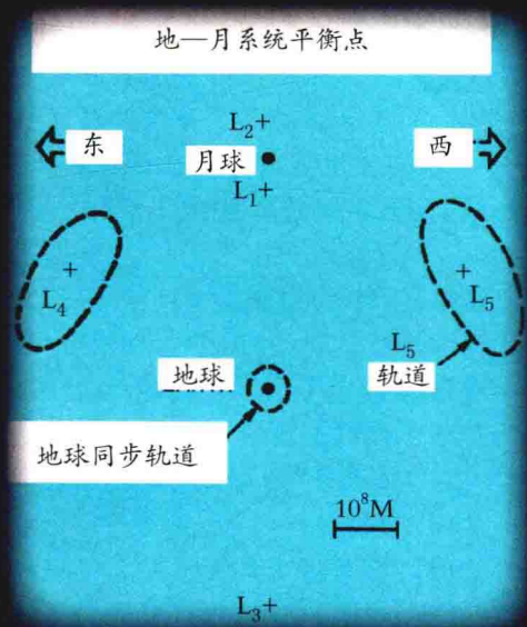
五个拉格朗日平衡点示意图
