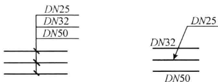
图 1-2 多根管线管径尺寸的标注
