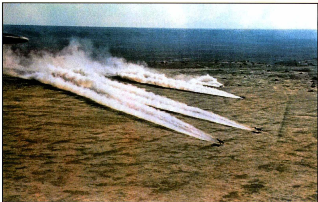
▲JG 27联队第1中队 (I./JG 27) 的几架Bf 109E-7/Trop飞机在起飞，飞机扬起的沙尘绵延上千米，飞机不安装沙尘过滤器绝对不行。
