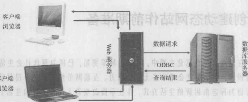
图 1-1-1 WWW 服务器的三层体系结构
