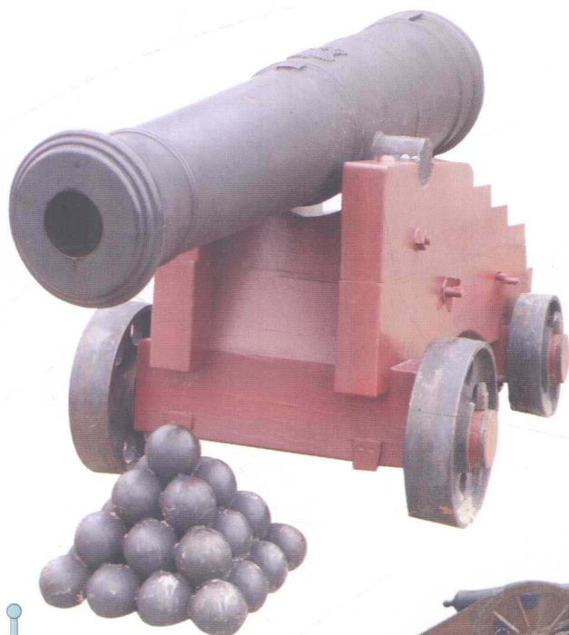
发射圆形铁制实心弹的火炮
