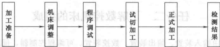
图 2-2 数控机床的工作过程
